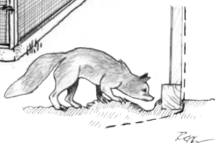
Figur 2. Genom att byta ut sexkantnätet i figur 1 mot ett svetsat nät och dra ut nätet under sockeln cirka 0,5 m kan uterummet göras rovdjurssäkert.
